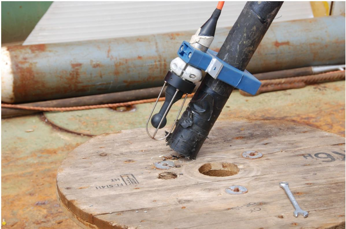
Figura 15 - Sistema di fissaggio degli idrofoni
