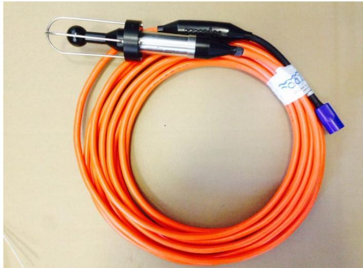
Figura 13 - Idrofono GP0280M
