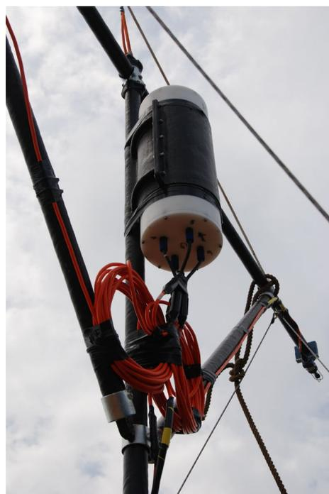
Figura 7 - Traliccio con idrofoni e dettaglio del contenitore stagno
